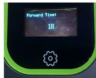
Pulse sobre el boton de ajustes de manera prolongada durante 4 segundos, hasta que escuche un aviso acústico , es entonces cuando el display mostrará un submenú que le permitirá seleccionar la intensidad de corriente para cargar el vehículo.
